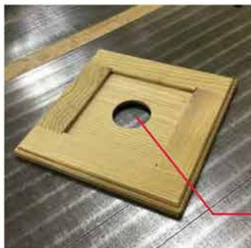
悩んだ結果、本体内部に空気を取り込まれるよう、各部分に溝を加工し、通気口としました。
