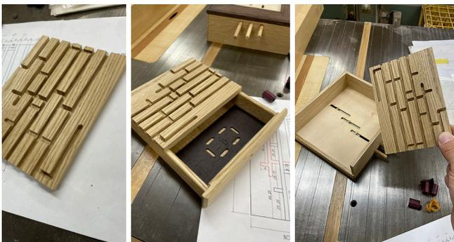
3. 次に、引出しです。引出しの上に、迷路のような溝を彫り込んだ板を仕込んであります。この溝に、上部の3本の棒からそれぞれ出ているピンがかみ合っています。この3つのピンの位置の組み合わせで、引出しの動きを制御しているのです。
