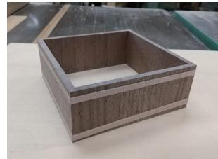
4. 坂道側面枠組み；坂道は45度の三角形なので、2つ分を接着し、1つの箱枠組んで接着、固定する。
