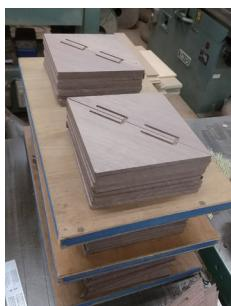
5. 鍵穴完成三角形；鍵穴となる坂道の内側の加工後。ボール盤とハンドルーラーで加工したが、苦戦した。やはりこのような作業はNC機械による加工が望ましい実感。
