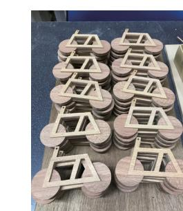
10. コチラも自転車のフレーム。糸鋸で内部を切り抜きます。
